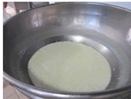
e) Affioramento del siero dopo la rottura della cagliata lo spino
