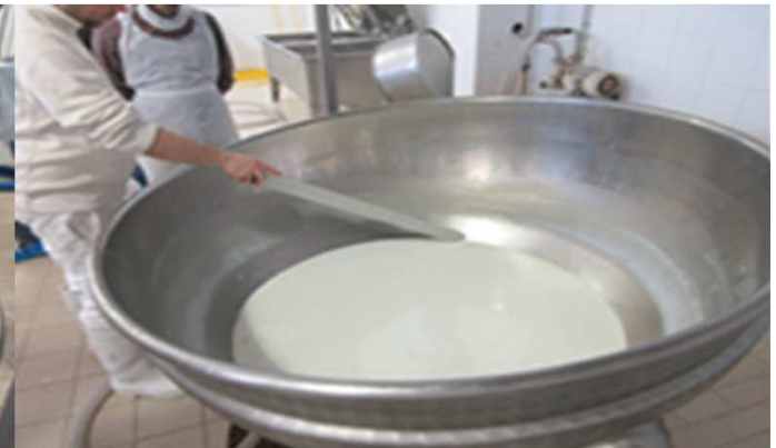
c) Rottura della cagliata con la spada
