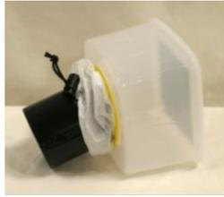
**Figure 3: contenitore per la raccolta degli insetti e tubo di aspirazione assemblati.**
