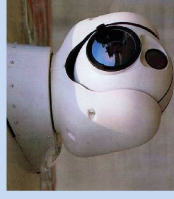
SISTEMA DI SCANSIONE MULTISPETTRALE ATM ENHANCED
