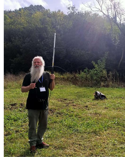
La radio telemetria consiste nel dotare la vespa di un trasponder attivo, che trasmette il segnale ad un sistema ricevente. Il trasponder attivo è molto pesante e richiede che le vespe si abituino al peso per alcune ore prima di essere rilasciate.
