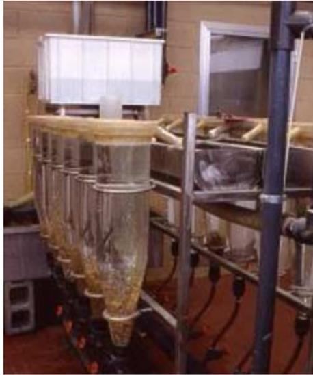
**Figura 11** – Bottiglie di Zug utilizzate per l'incubazione
