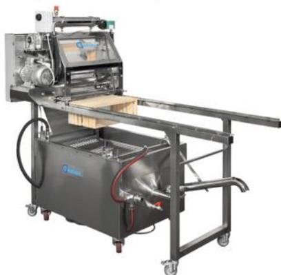
**DISOMELTER**, disopercolatrice a coltelli vibranti riscaldati completa di telaio e fondicera diretto. Il fondicera separa la cera fusa dal miele, mantenendo integre le proprietà del prodotto.
