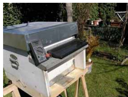
Figure 9-12. Apparecchiatura per l'allontanamento delle varroe in fase foretica per mezzo di una scarica elettrica
