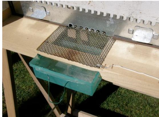
Figure 1-2-3-4. Apparecchiatura per l'allontanamento delle varroe in fase foretica per mezzo di una scarica elettrica
